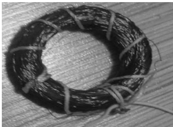
Рис. 13. Выходное трансформаторное кольцо в качестве тора.
