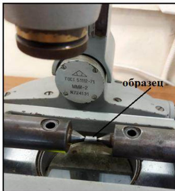
Рисунок 1 – Микроскоп малый инструментальный ММИ-2 в процессе замера параметров резьбы на испытуемом образце.
